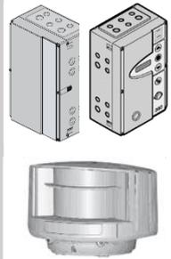
Der Absicherungssensor Bea LZR-i110 wird in die Zusatzsteuerung (2033793) angeschlossen. Diese ist bereits vorgefertigt über das Systemkabel verbunden. Es muss die Systemleitung von der Platine (Y-Stecker) in die Antriebsteuerung auf die Klemme X30 = A12 (Abstellbereich Absicherung) und auf die Klemme X20 A10 + A11 angeschlossen werden.
